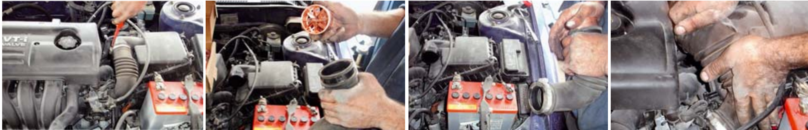
Den Filterung kann jeder Kfz-Handwerker in wenigen Minuten einbauen: Zunächst wird der Luftzufuhrschlauch abgeklemmt.
